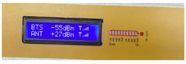
Cuando la señal de entrada BTS está entre -55dBm y -70 dBm el repetidor está trabajando con niveles ideales para funcionar a máxima potencia.
