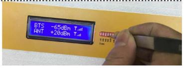
Puede ajustar la potencia tanto de entrada como de salida moviendo los switches que aparecen al lado derecho de la pantalla. Hacia arriba estará atenuando la señal y lo contrario hacia abajo
